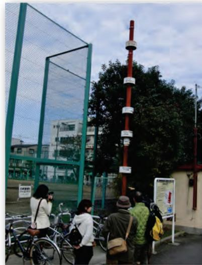
南砂三丁目公園の横には、水位標と地下水位の測定装置が設置していました。高度経済成長の時代に、地下水の汲み上げで地盤が沈下していったようですがよくわかります。町並みを歩いていくと、ここが海面下であるというのが不思議でなりません。
